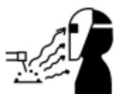
**SVAŘOVACÍ OBLOUK MŮŽE ZPŮSOBIT POPÁLENINY:** Není dovoleno dívat se přímo nechráněnými očima na elektrický oblouk. Vždy používejte ochrannou masku nebo kuklu s vhodným filtrem. Přihlížející osoby, které se nacházejí v blízkosti, chráňte pomocí nehořlavých obrazovek, které pohlcují záření. Chraňte nezakryté části těla vhodným ochranným oděvem z nehořlavého materiálu.
