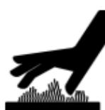
**SVAŘOVANÉ MATERIÁLY MOHOU POPÁLIT:** Nikdy se nedotýkejte svařovaných částí nechráněnými částmi těla. Při dotyku a přemísťování svařovaného materiálu vždy používejte svařovací rukavice a kleště.
