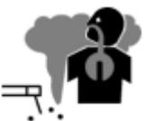
**VÝPARY A PLYNY MOHOU BÝT NEBEZPEČNÉ:** Během procesu svařování se vytváří škodlivé výpary a plyny, které jsou nebezpečné pro zdraví. Zabraňte vdechování těchto výparů a plynů. Pracoviště by mělo být dostatečně větrané a vybaveno odvětrávacím zařízením. Nesvařujte v uzavřených místnostech. Povrchy částí, které mají být svařovány, by neměly obsahovat chemické nečistoty, jako jsou odmašťovací látky (rozpuštědla), které se při svařování rozkládají a vytvářejí toxické plyny.
