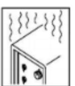
**PŘETÍŽENÍ MŮŽE ZPŮSOBIT PŘEHŘÁTÍ:** Neprodlužujte cykly svařování, mezi svařovacími cykly dovolte, aby se zařízení ochladilo. V případě nadměrného zahřívání se zařízení, zkrátě dobu svařovacího cyklu nebo snižte svařovací proud.
