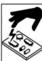
**STATICKÝ VÝBOJ MŮŽE POŠKODIT TIŠTĚNÝ OBVOD:** Před dotknutím se tištěných desek a části elektrického systému je potřeba si navléci uzemňovací zápevní řemínek. Použijte antistatické obaly pro skladování a přepravu prvků elektrického systému.
