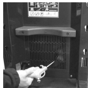
Důkladně profoukněte ventilátor spotřebiče
