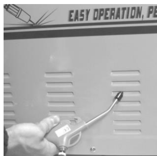
Profoukněte boční větrací zařízení
